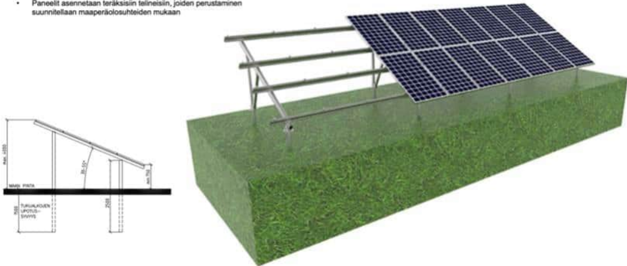
Kuva 4-2. Periaatekuva aurinkopaneelikennostosta. Lähde: Ilmatar Solar Alajärvi Oy 2023
