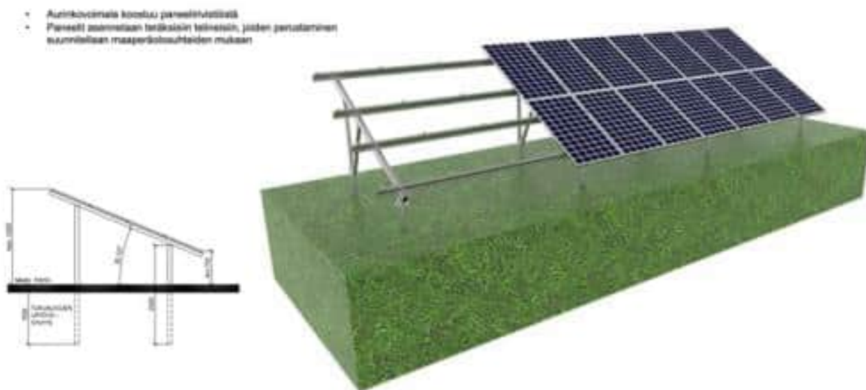
Kuva 1-3. Periaatekuva aurinkopaneelikennoistosta. Ilmatar Solar Alajärvi Oy 2023.
